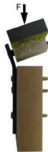
Abb. 0: Modell einer 23-A3 Fraktur. Der Pfeil veranschaulicht die axiale Lasteinleitung.
