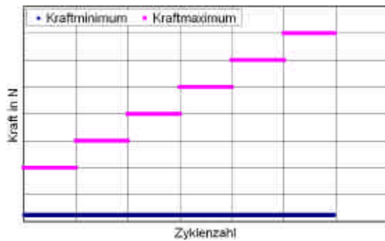
Abb. 0: Schema des axialen Stufentests
